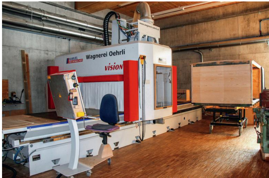
Auf der 5-Achs-CNC-Maschine werden Sattelbäume und Sonderanfertigungen millimetergenau hergestellt.
