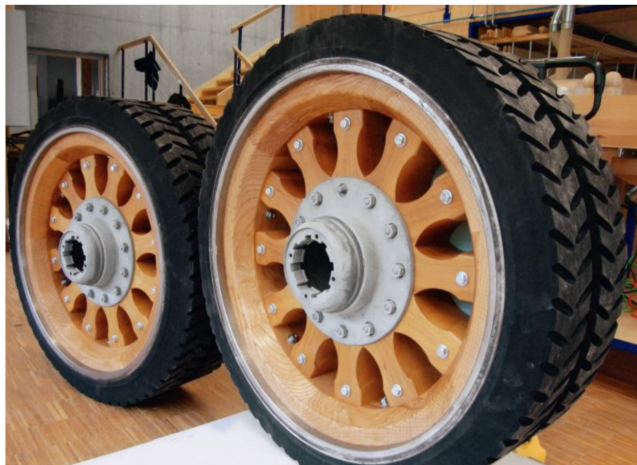
Für einen Saurer-Oldtimer mit Baujahr 1921 hat Oehrli die Hinterräder originalgetreu nachgebaut.
